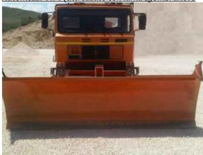
Automezzi 4 x 4 (attrezzato con lama sgombraneve)
